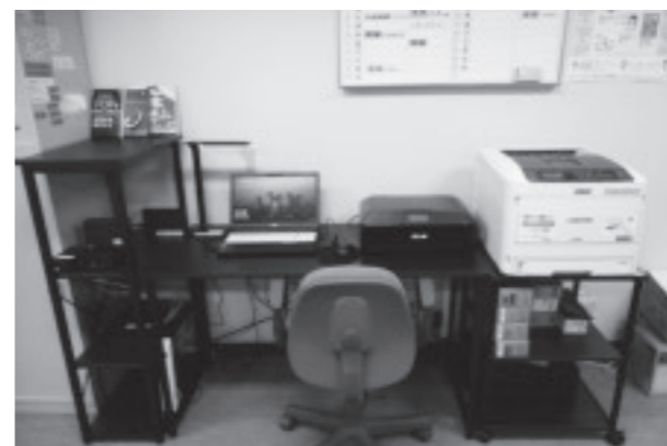
パソコンと周辺機器 左からONU、ルーター、スイッチングハブ、ハードディスク(左ラック内)、ノートパソコン(中央テーブル)、カラーレーザープリンター(右テーブル)
